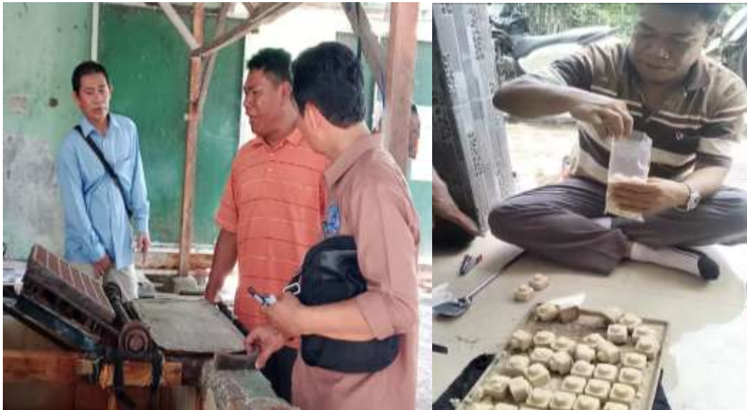
Gambar 2. Pendampingan prosen produksi garam bata (kiri: pencetakan garam bata; kanan: packing garam bata)
