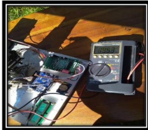
Gambar 4.15 Pengukuran Tegangan Panel Surya
