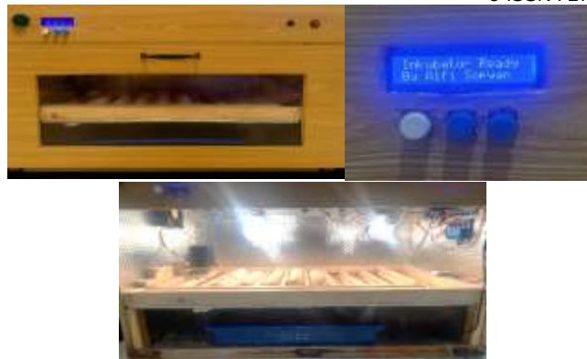
Gambar 8 Hasil Realisasi Desain Inkubator dan Implementasi Komponen
