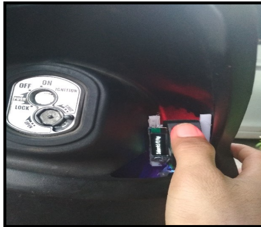
Gambar 4 Tampilan Autostarter Sepeda Motor
